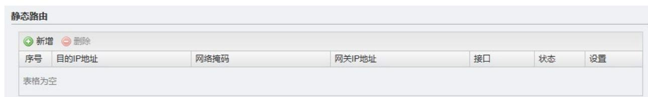
**目的地址/网络掩码** 设置目的地址和子网掩码，确定路由生效的网段。
