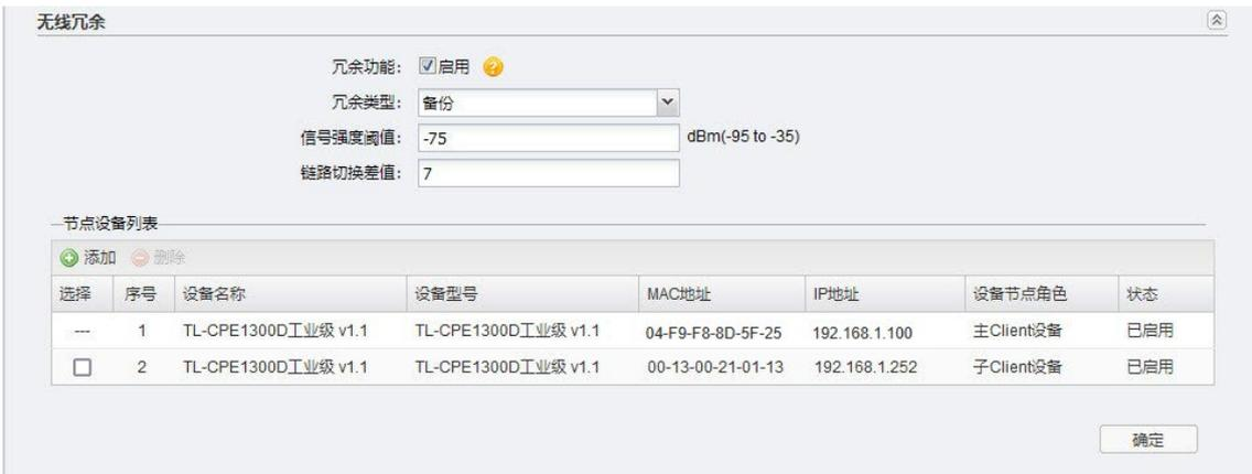
在备用链路 Client 设备的 Web 页面中，用户可在无线冗余界面查看相关配置和全节点设备列表，但无法进行任何编辑操作。操作界面置灰，其他所有信息与主链路 Client 设备相同，如下图所示：
