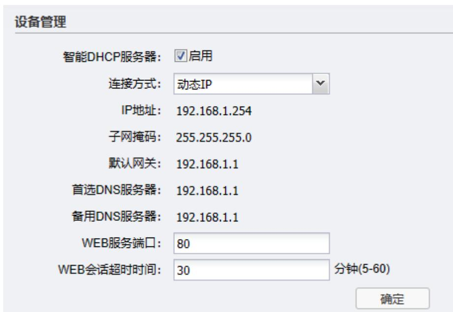
**智能 DHCP 服务器** 可启用 DHCP 服务器。DHCP 服务器能够自动给局域网中的设备分配 IP 地址。
