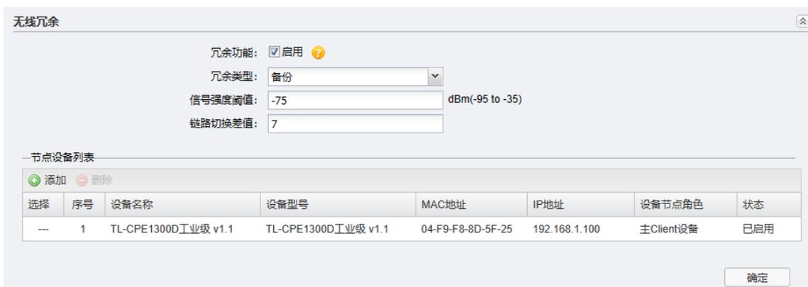
如上图所示，手动启用冗余功能，本设备会自动设备为主链路 Client（主 Client 设备），冗余类型选择“备份”（默认类型），点击<确定>使配置生效。
